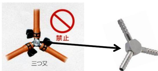
正しい接続方法 (ヒューズガス栓を使用し分岐)
