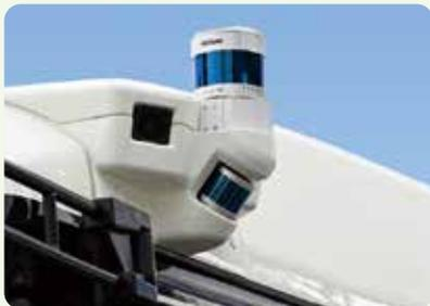
主要なセンサーであるLiDAR。レーザーを照射して、対象物までの距離や性質を調べます。
