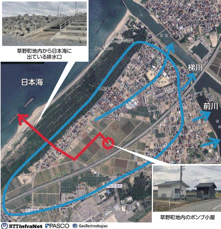
前川左岸地区の排水の流れ(青色線)と、草野町地内にある農業用ポンプの排水ルート(赤色線)
