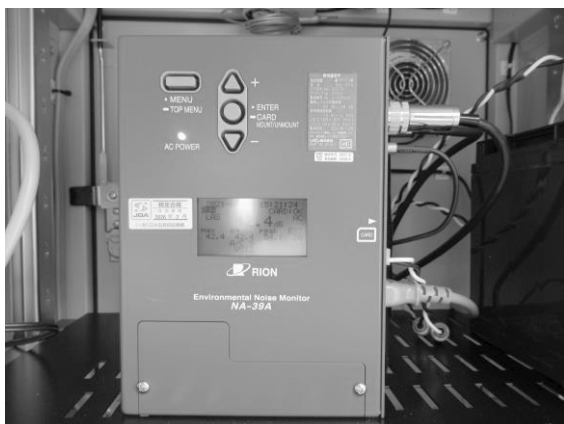
航空機騒音自動観測装置（リオン社製 NA-39A）
