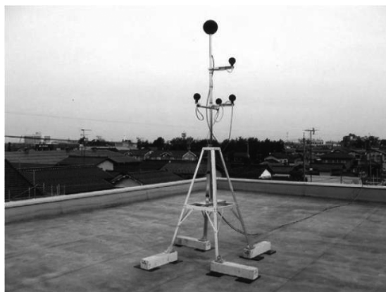
航空機騒音自動観測装置（リオン社製 NA-39A）
